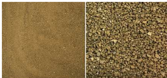
Figure 1 : Séparation de la fraction fine (gauche) et grossière (droite) d'un échantillon de sol
